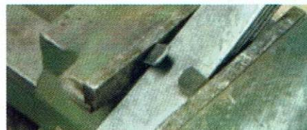
Per Schraubstock und Hammerschlag werden die Klammern wieder verschlossen.
